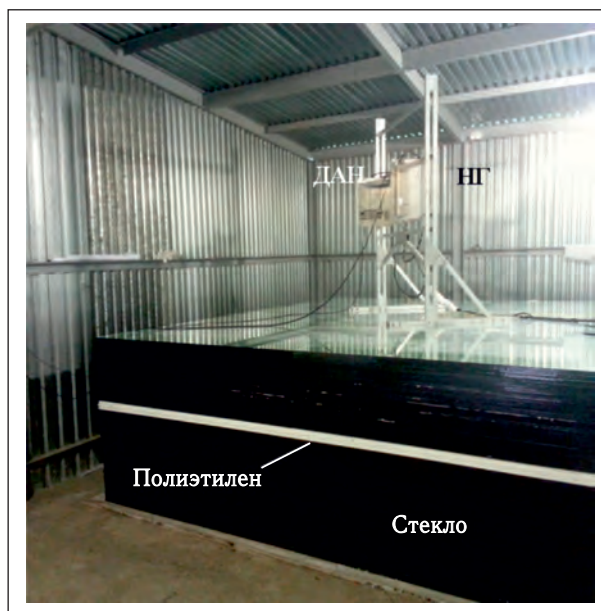
Рис. 19. Модель планетарного грунта с размещенными над ней детектором альбедных нейтронов (ДАН) и нейтронным генератором (НГ)
