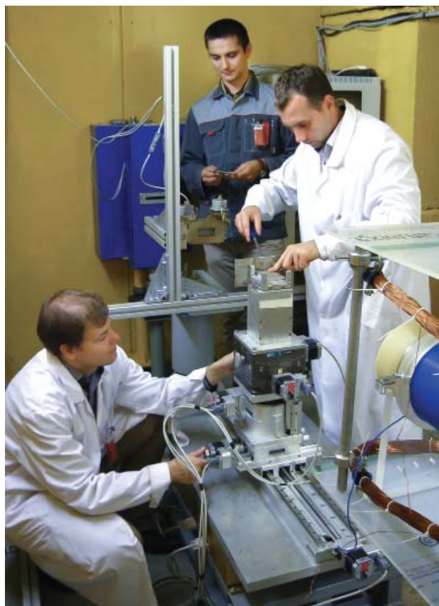
Лаборатория нейтронной физики им. И. М. Франка. Настройка рефлектометра GRAINS: устанавливается рефлектометрическая ячейка типа «твердое тело – жидкость» с использованием монокристалла кремния в качестве твердой подложки (фото М. В. Авдеева)
