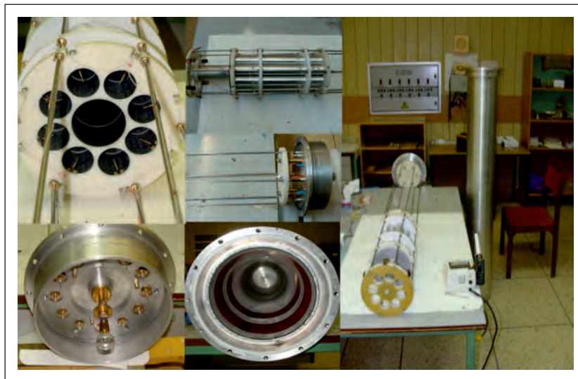
Рис. 13. Электродная система нового протонного телескопа
