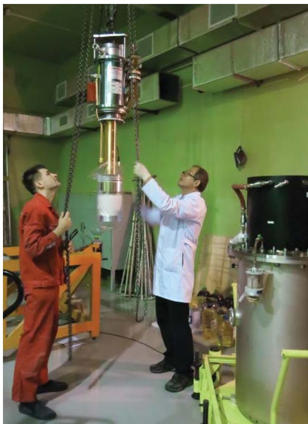
Лаборатория нейтронной физики им. И. М. Франка. Монтаж новых модуляторов установки ИРЕН
