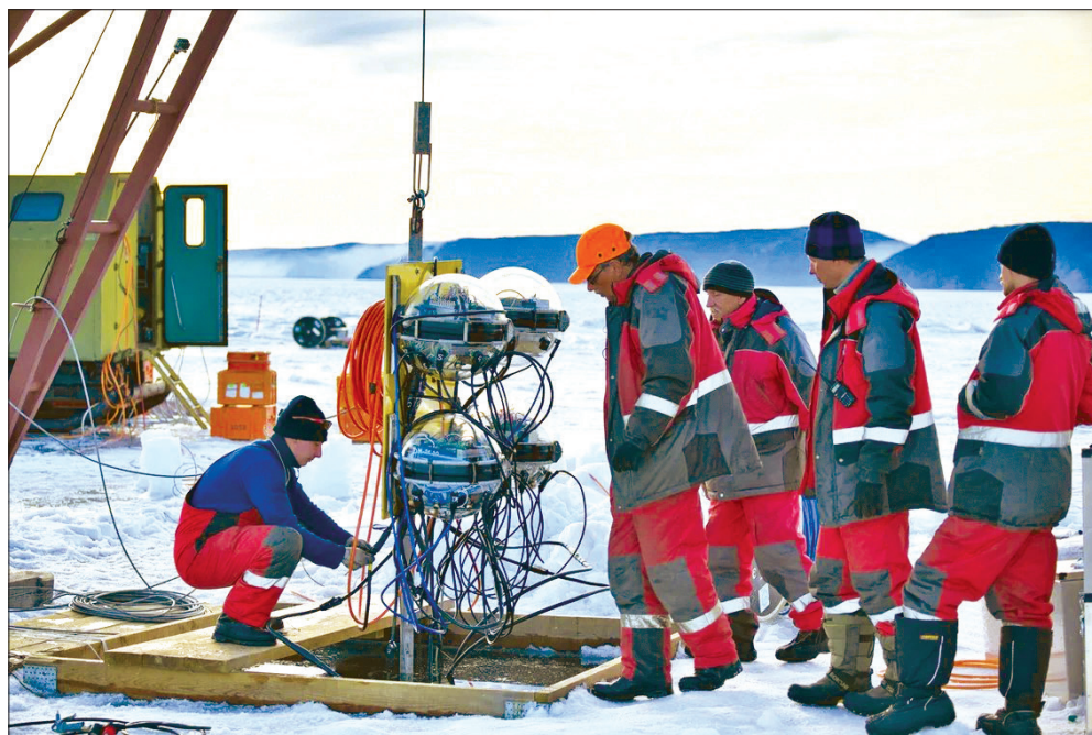
Байкал. Монтаж центра нового, седьмого кластера телескопа «Байкал-ГВД»
