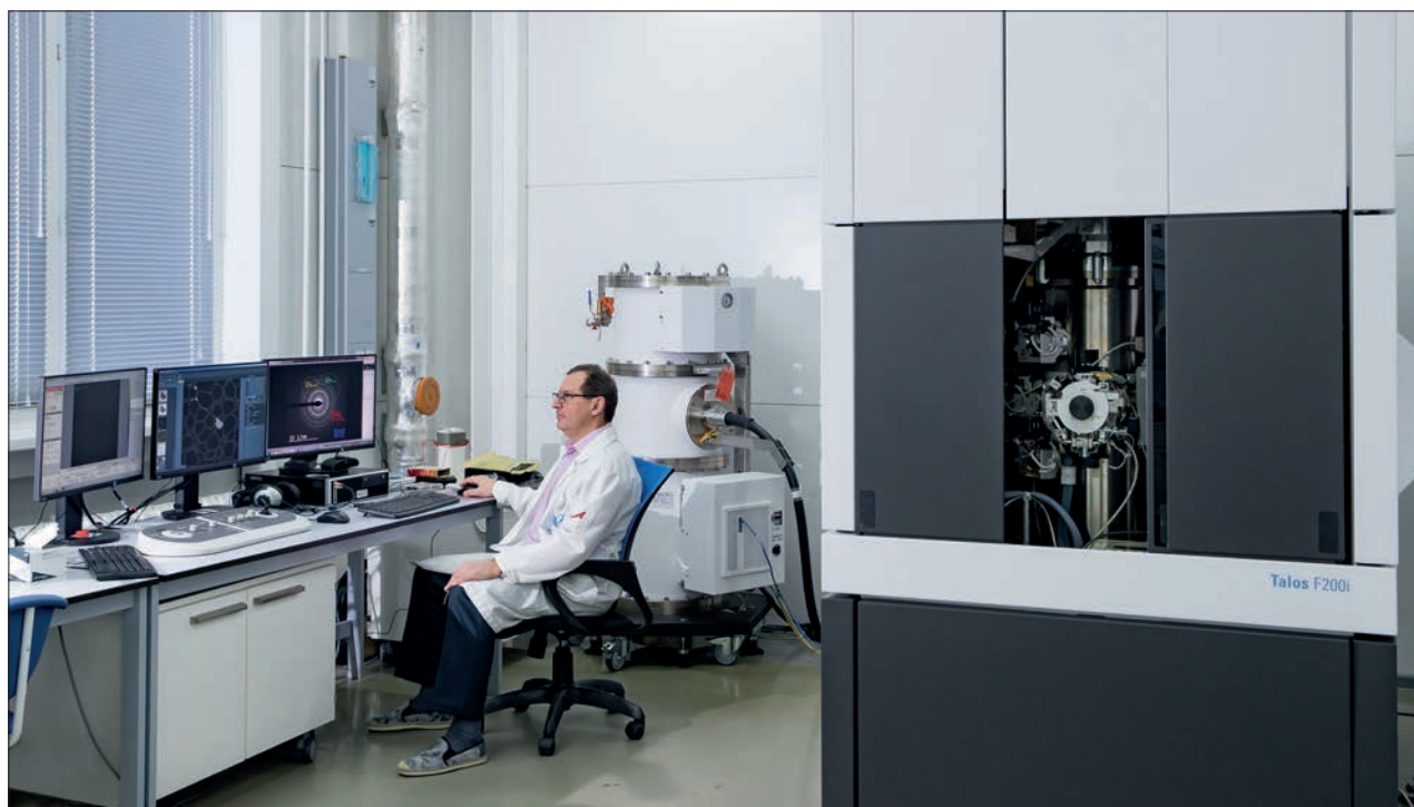
Лаборатория ядерных реакций им. Г. Н. Флорова. Электронный микроскоп Talos F200i для исследования радиационных эффектов в твердых телах и нанотехнологических приложений
