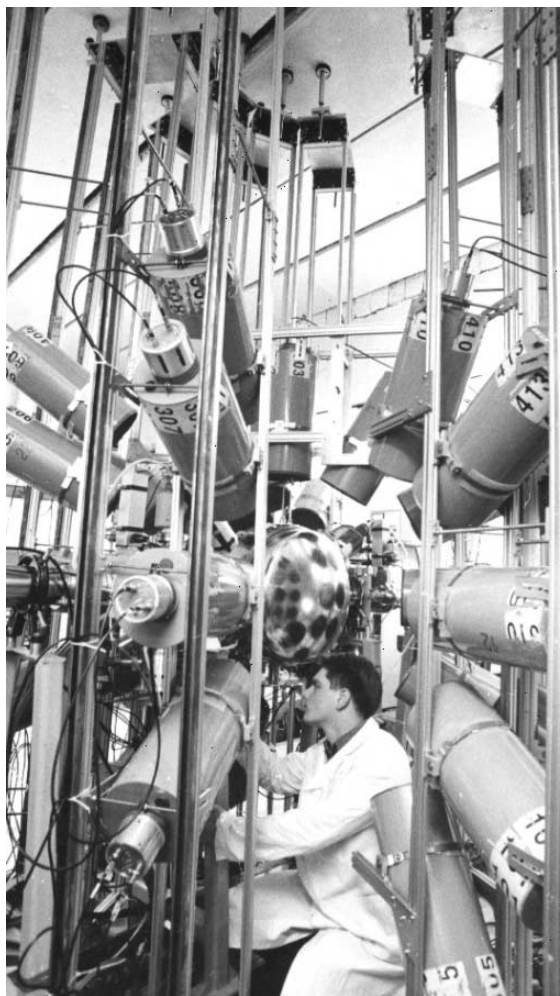
Лаборатория ядерных реакций им. Г.Н.Флерова. Экспериментальная установка для изучения реакций слияния-деления слабовозбужденных компаунд-ядер
