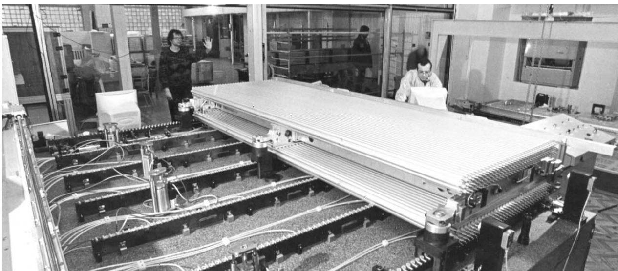
Лаборатория ядерных проблем им. В.П.Джелепова. Участок сборки и испытания дрейфовых детекторов для экспериментов по теме ATLAS в ЦЕРН
