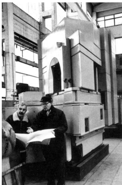
Опытное производство ОИЯИ. Контрольная сборка узлов нового подвижного отражателя ОП-3 для ИБР-2
