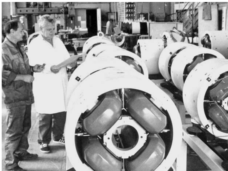
Опытное производство. Электрофизическое оборудование, изготовленное для Циклотронного центра в Братиславе (Словакия)
