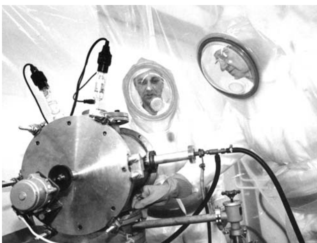
Лаборатория ядерных реакций им. Г. Н. Флерова. На циклотроне У-400 с использованием уникальной мишени из калифорния-249, изготовленной совместно со специалистами НИИАР (Димитровград, Россия), проводятся эксперименты по синтезу элемента 118
